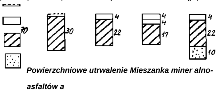
Rys. 4. Przykładowe wybrane konstrukcje nawierzchni utwardzonego pobocza z kruszywa łamanego niezwiązanego
